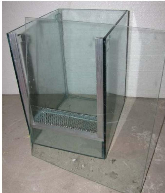
7) Coloco las costillas que mantendrán estable el ancho del terrario y que me permitirán soportar la tapa
